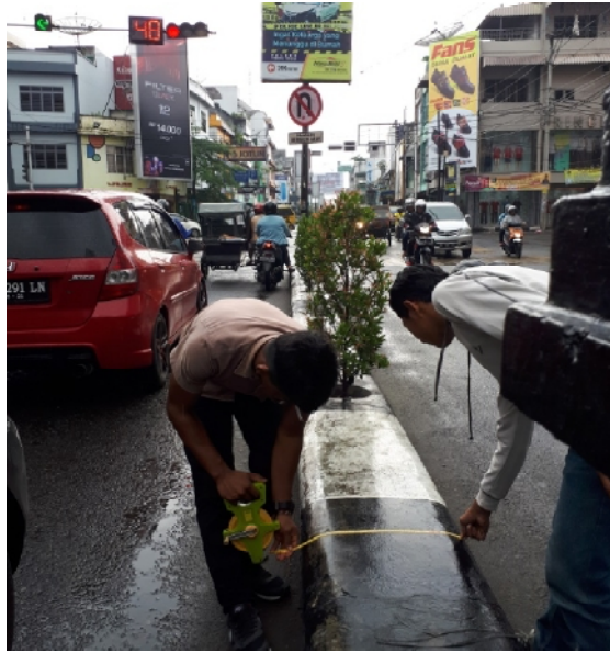
Gambar L5 : Pengukuran median jalan
