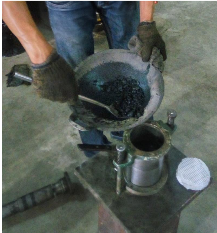
Gambar L.11: Penuangan Campuran Ke Cetakan.
