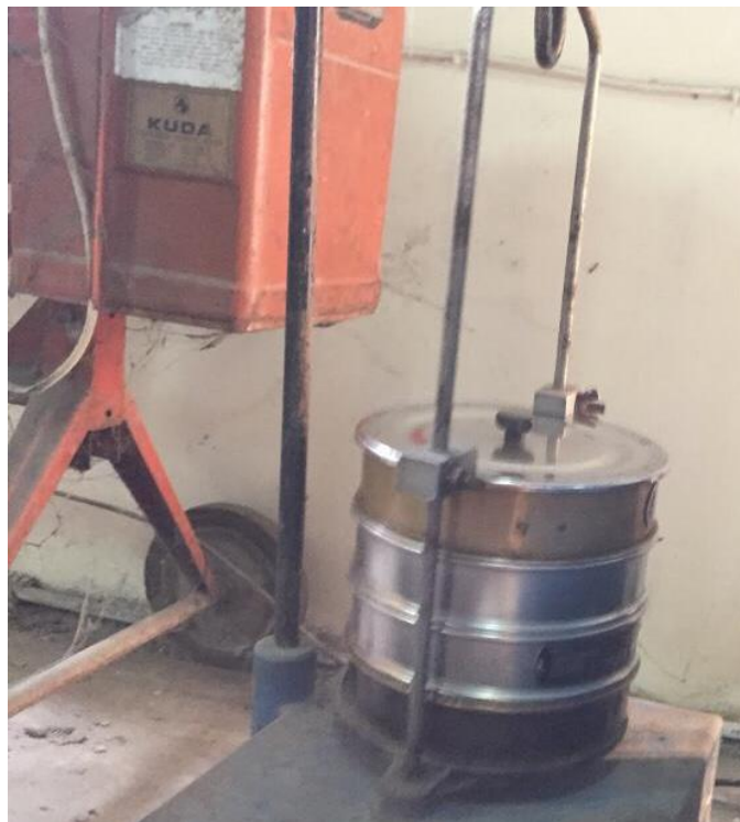
Gambar L.4: Pengayakan Menggunakan Sieve Shaker .
