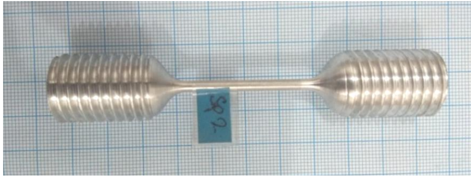
Gambar 4.12 Spesimen 2 sebelum uji tarik dinamik
