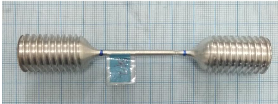
Gambar 4.15 Spesimen 2 sesudah uji tarik dinamik
