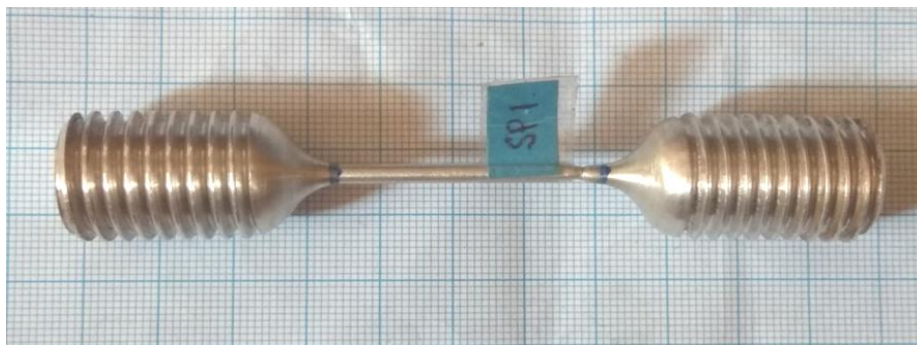
Gambar 4.14 Spesimen 1 sesudah uji tarik dinamik
