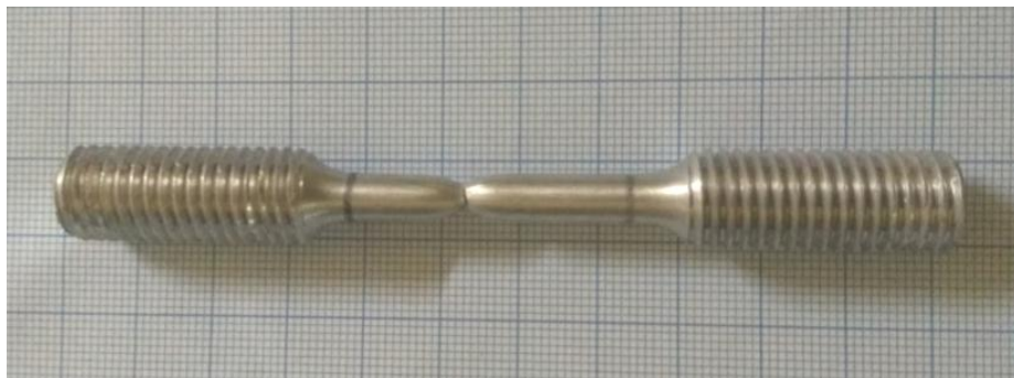
Gambar 4.6 Hasil uji tarik statis pada spesimen 3 aluminium paduan
