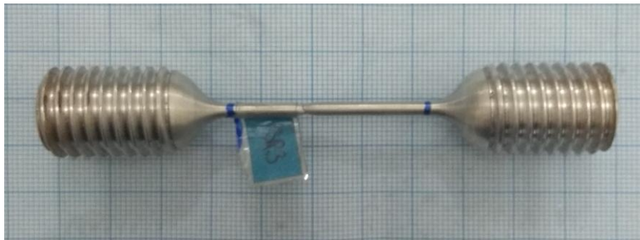
Gambar 4.16 Spesimen 3 sebelum uji tarik dinamik
