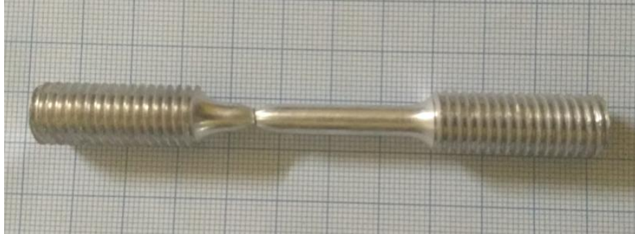
Gambar 4.4 Hasil uji tarik statis pada spesimen 1 aluminium paduan
