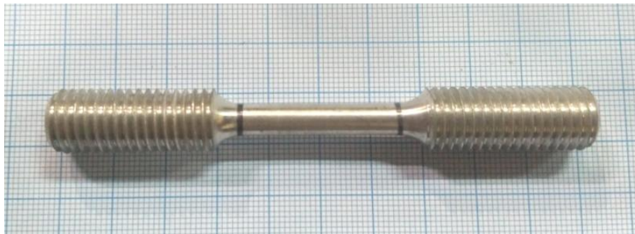
Gambar 4.2 Sebelum uji tarik statis pada spesimen 2 aluminium paduan
