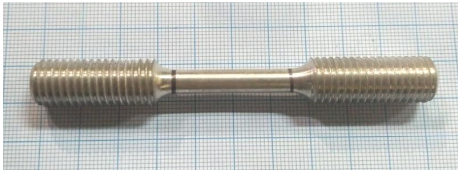
Gambar 4.3 Sebelum uji tarik statis pada spesimen 3 aluminium paduan
