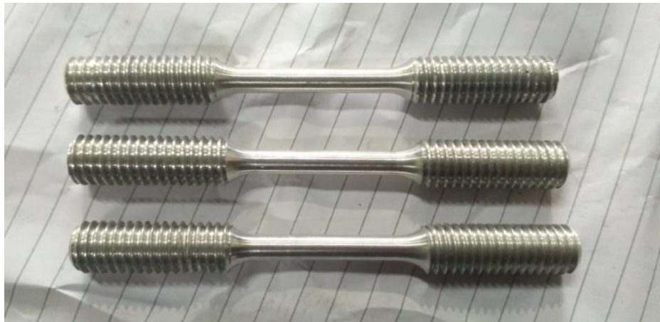
Gambar 3.6 Spesimen uji statis bahan aluminium paduan
