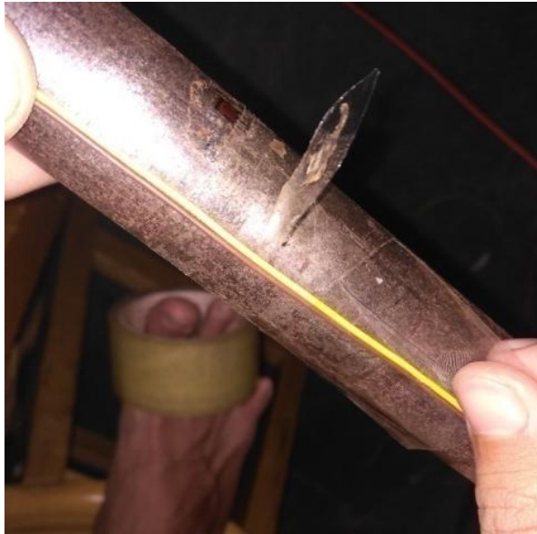
Gambar 3.15 Pemasangan kabel strain gauge
