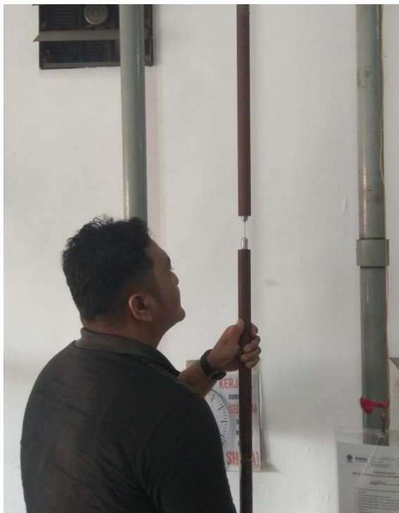
Gambar3.21 Pemasangan spesimen uji tarik dinamik
