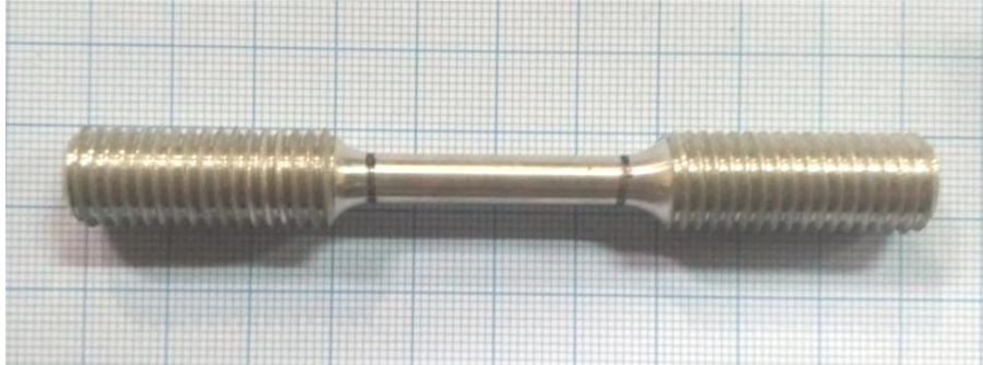
Gambar 4.1 sebelum uji tarik statis pada spesimen 1 aluminium paduan
