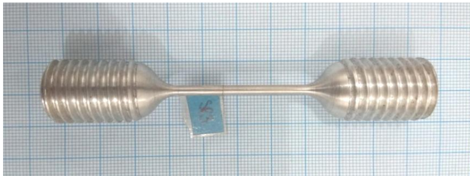
Gambar 4.13 Spesimen 3 sebelum uji tarik dinamik
