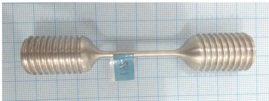
Gambar 4.11 Spesimen 1 sebelum uji tarik dinamik
