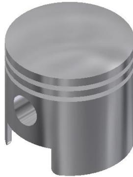
Gambar 4.19 Desain Piston Mesin Motor Bakar Menggunakan Perangkat Lunak *Autodesk Inventor*
