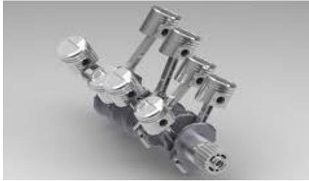
Gambar 2.4 Motor V (<http://teknikmesinzone.blogspot.com>).
