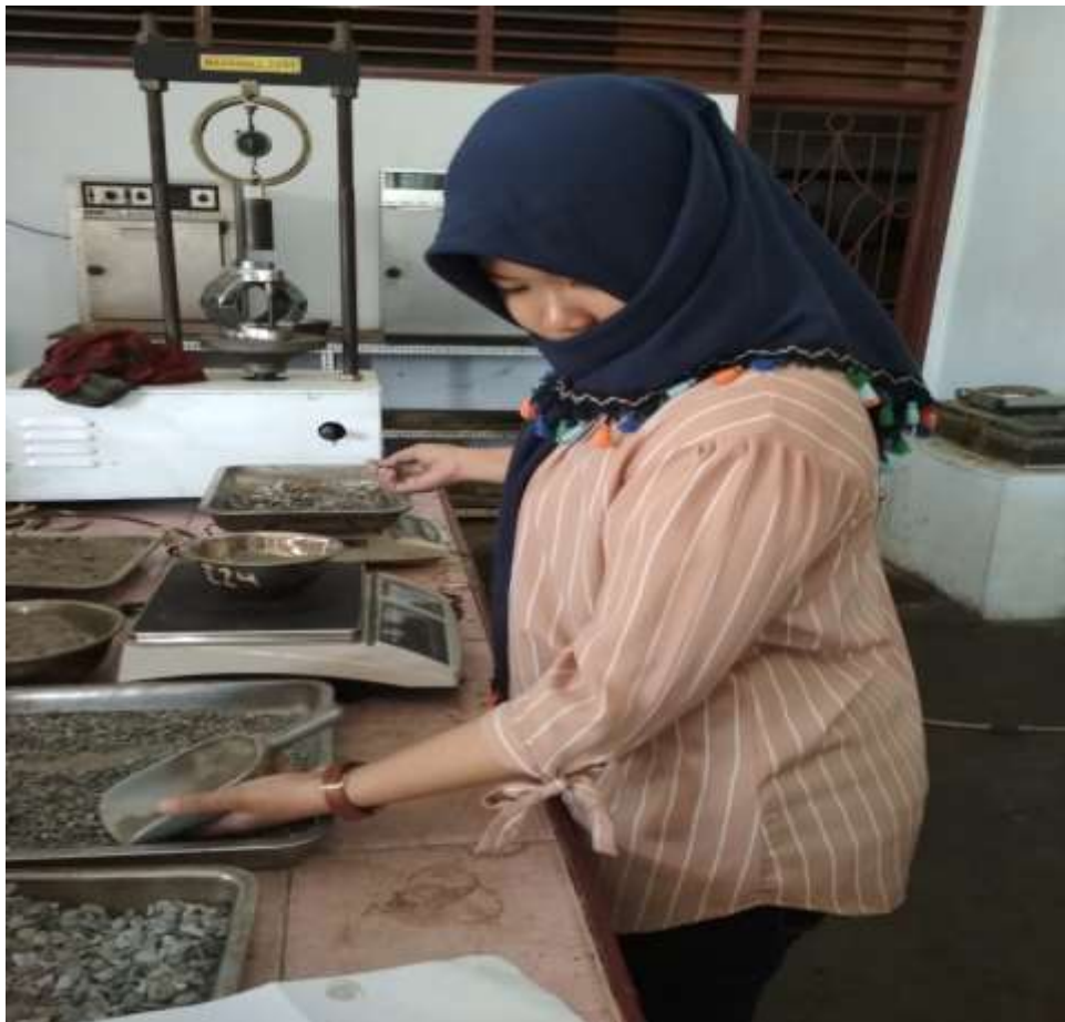
Gambar L4: Mencampur agregat halus, agregat kasar, Serat daun nenas sebelum dipanaskan dan dicampur dengan aspal.
