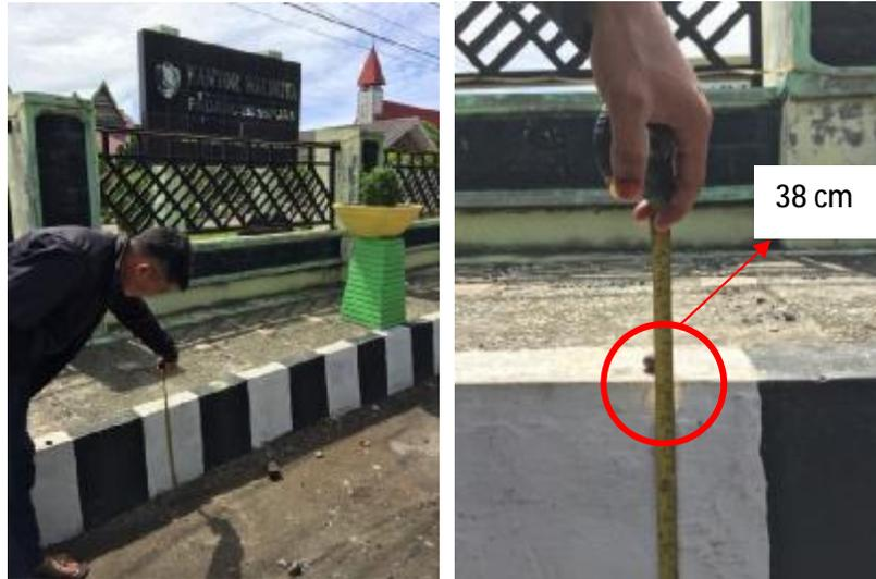
Gambar L.4 : Pengukuran tinggi jalur pedestrian pusat Kota Padangsidempuan
