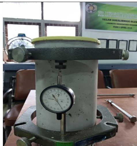
Pemasangan dial modulus elastisitas
