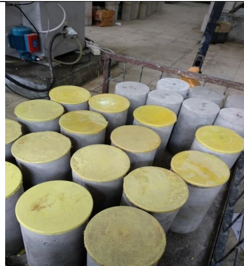
Benda uji yang telah di capping
