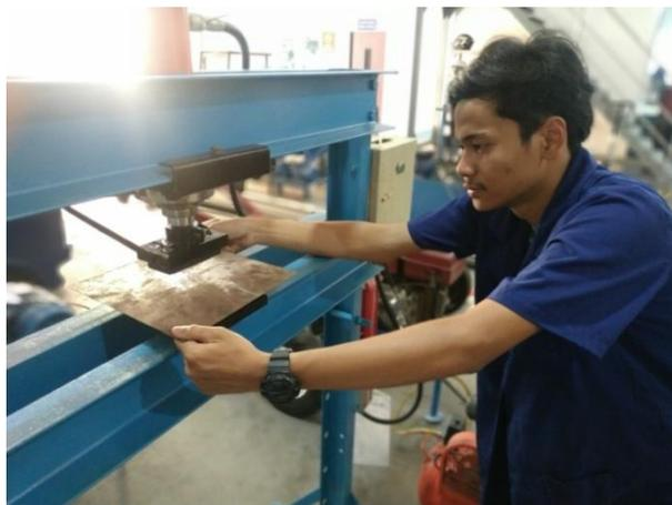
Gambar 3.8 Proses Peletakan Pelat Baja Di Atas *Die*
