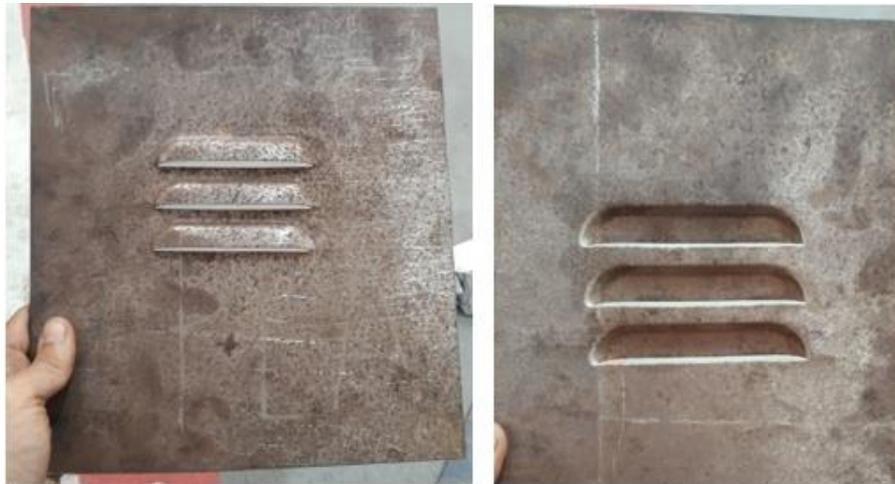
Gambar 4.2 Pelat Hasil Penekanan Metode *Lanzing* dengan Pelat 1 mm
