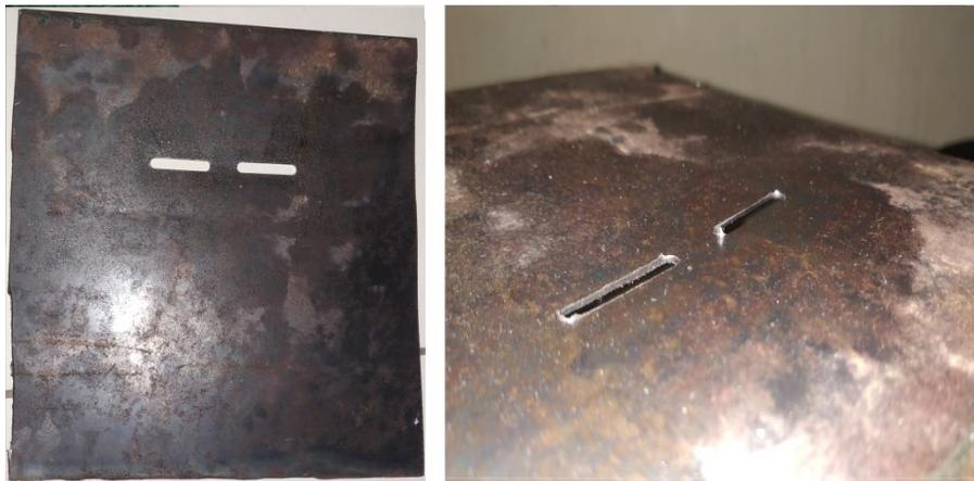
Gambar 4.15 Pelat Hasil Penekanan Metode *Blanking* dengan Pelat 1,2 mm
