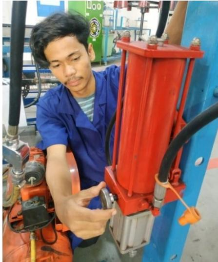
Gambar 3.11 Proses Melepas Angin Pada Mesin *Press Tool*
