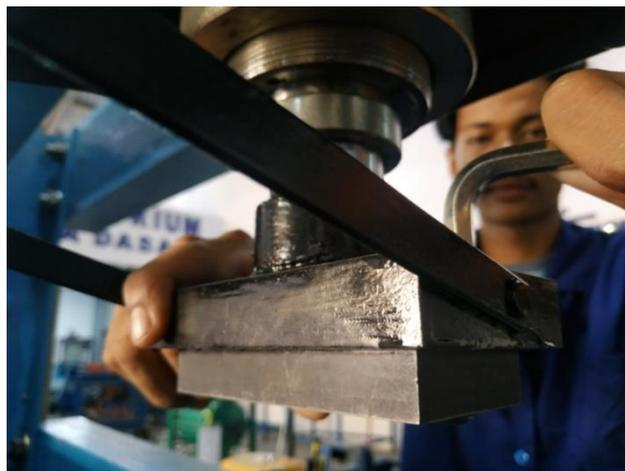
Gambar 3.6 Proses Pemasangan Komponen *Punch* dan *Die*
