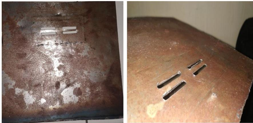
Gambar 4.11 Pelat Hasil Penekanan Metode *Blanking* dengan Pelat 1 mm
