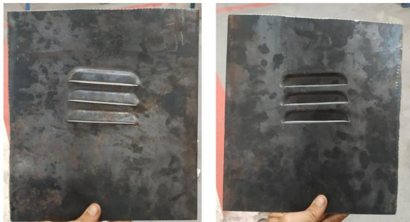
Gambar 4.6 Pelat Hasil Penekanan Metode *Lanzing* dengan Pelat 1,2 mm
