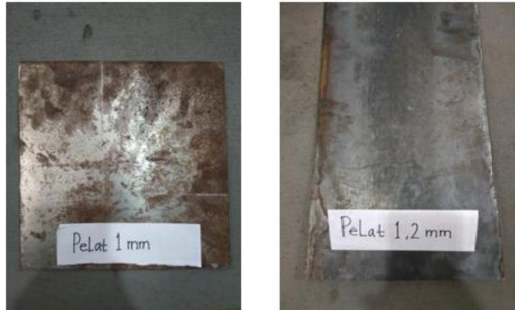
Gambar 3.5 Pelat Baja Ketebalan 1mm dan 1,2 mm.
