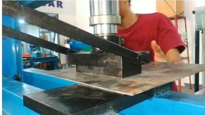
Gambar 4.5 Proses Penekanan Metode *Lanzing* dengan Pelat 1,2 mm
