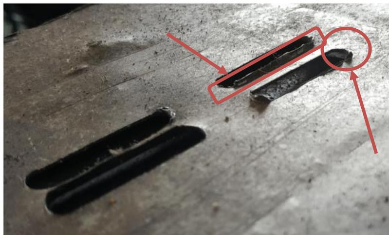
Gambar 4.13 Cacat produk Pelat 1 mm *Blanking*
