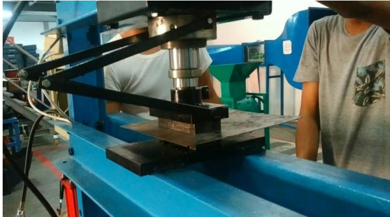
Gambar 4.14 Proses Penekanan Metode *Blanking* dengan Pelat 1,2 mm
