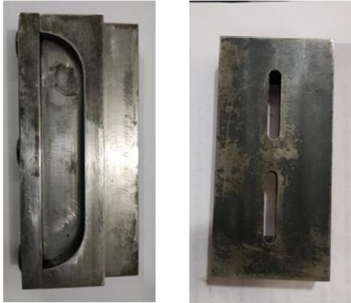
Gambar 3.3 Komponen *Die* Berbentuk *Lanzing* dan *Blanking*
