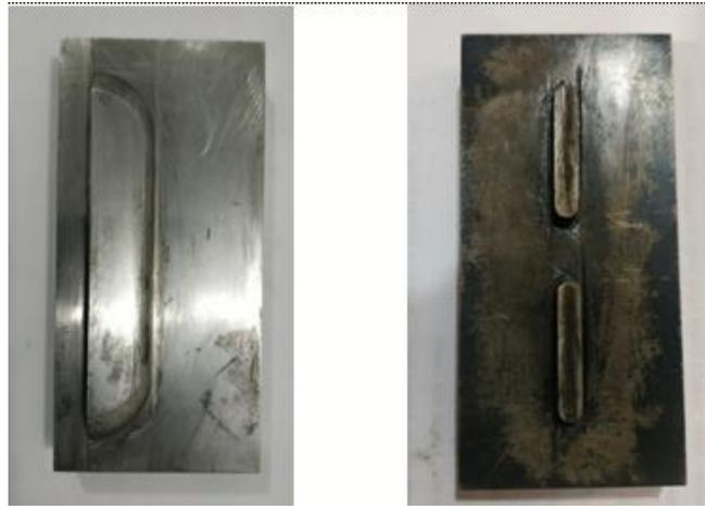
Gambar 3.2 Komponen *Punch Lanzing* dan *Blanking*
