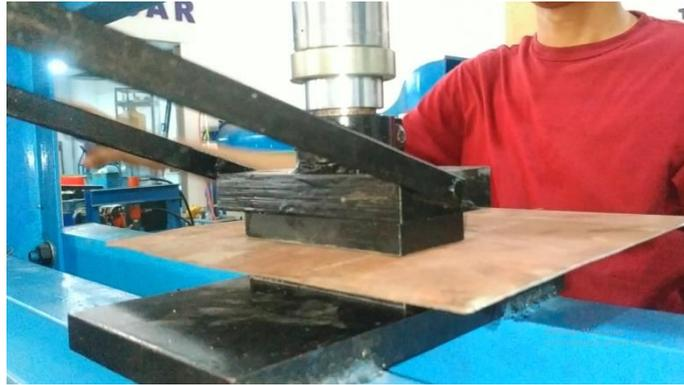
Gambar 4.1 Proses Penekanan Metode *Lanzing* dengan Pelat 1 mm
