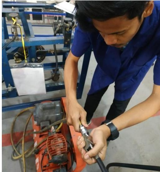
Gambar 3.7 Proses Menghubungkan Kompresor ke Mesin Pres Hidrolik
