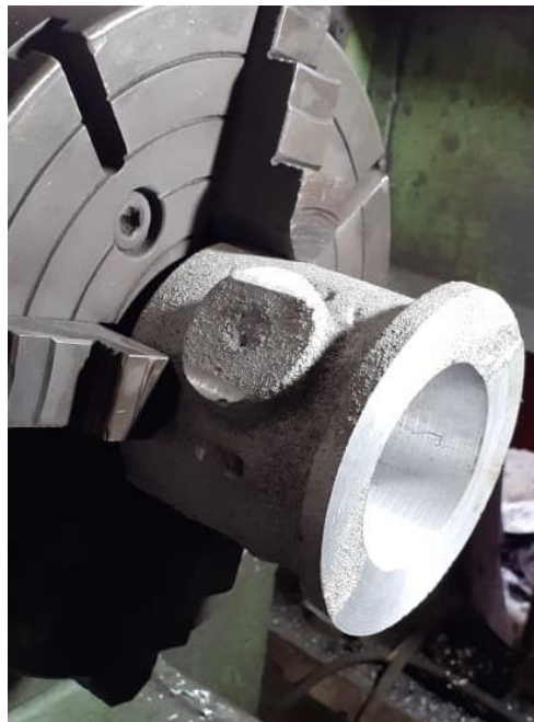
Gambar 4.20 proses pembubutan benda kerja
