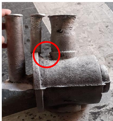
Gambar 4.18 Cacat Rongga Udara
