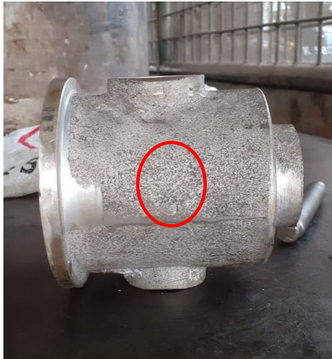
Gambar 4.19 Cacat Lubang Jarum
