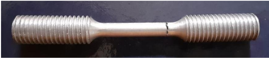
Gambar 4.29 Spesimen 1 yang sudah di uji
