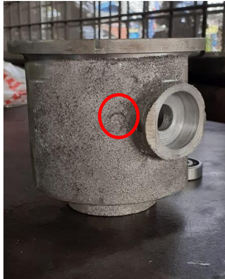
Gambar 4.17 Cacat rontokan cetakan
