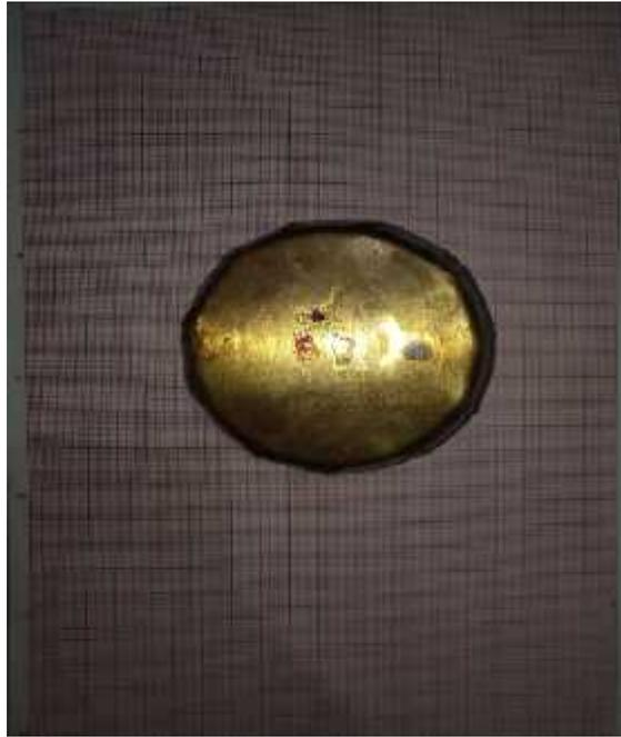
Gambar 4.8 Gamabar produk spesimen kuningan 0.3 setelah pengujian pada bagian bawah.
