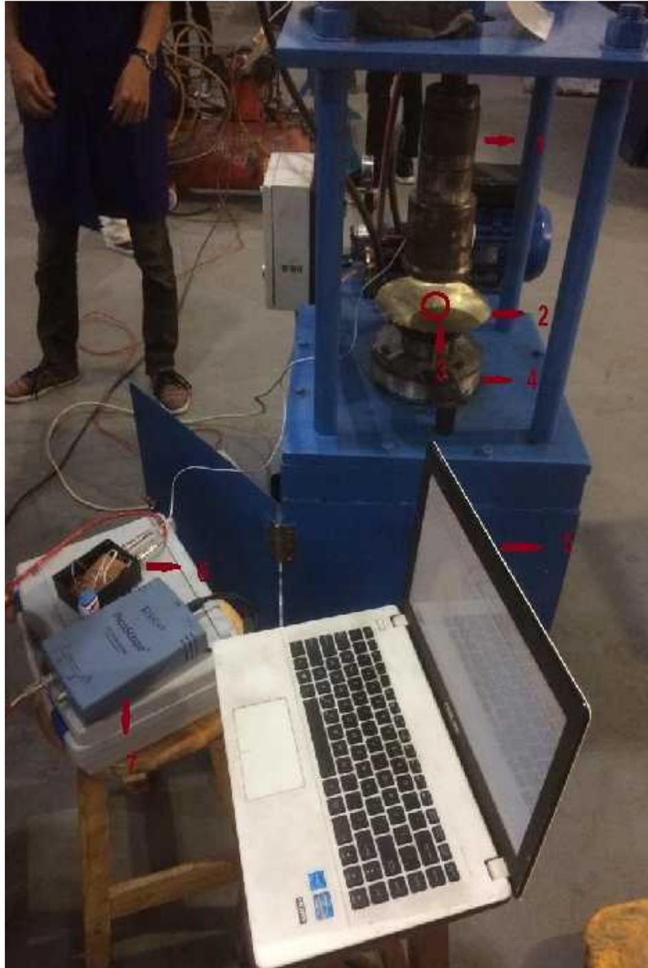
Gambar3.15 Pemasangan output *Oscilloscope* pada laptop
