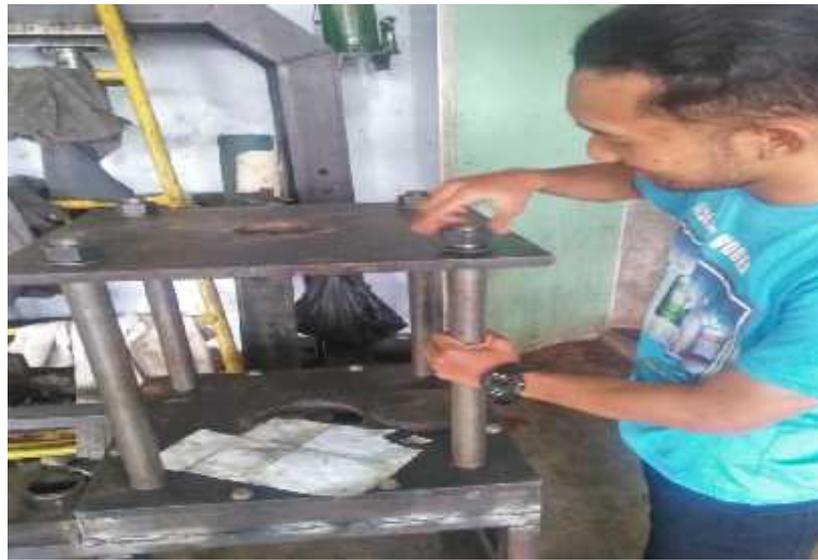
Gambar 3.9 Pembuatan Mesin penekan pembentuk logam
