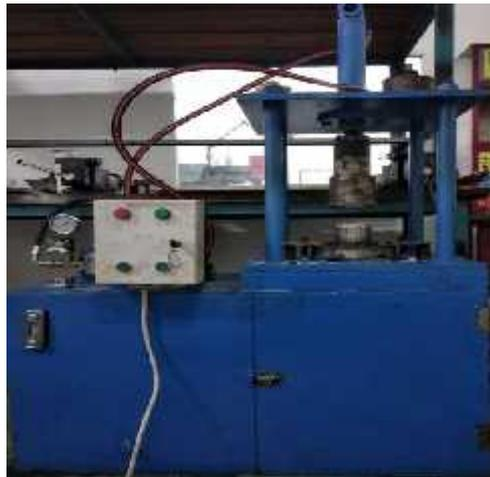
Gambar 3.1 Mesin pembentuk logam(*deep drawing*)
