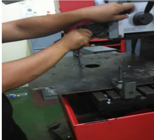
Gambar 3.30 Pengeboran Untuk Tempat Dudukan Bearing
