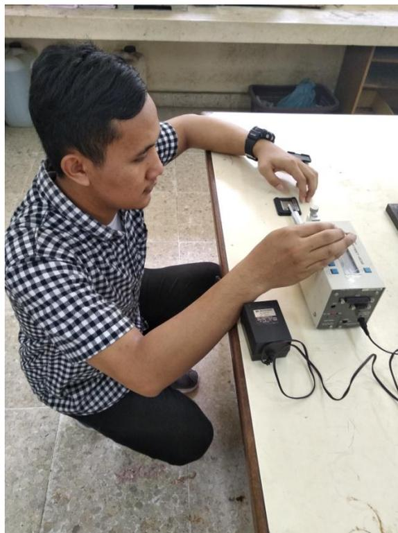
Gambar saat sedang melakukan pengujian kekasaran permukaan spesimen dengan menggunakan alat roughness test di Laboratorium Material Test Politeknik Teknologi Kimia Industri Medan.
