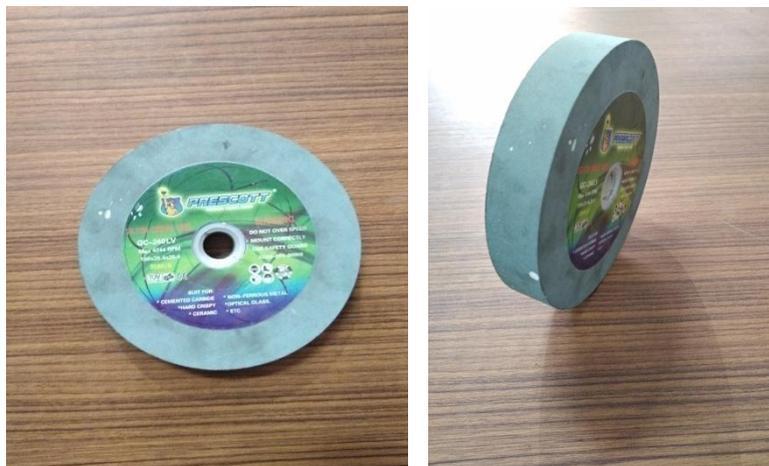
Gambar 3.2 Batu Gerinda( *Silicon carbide Wheel GC-240 LV* )
