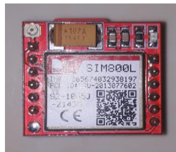
Gambar 6 : Module sim 800 L
