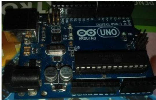
Gambar 2.6 Arduino Uno R3.
