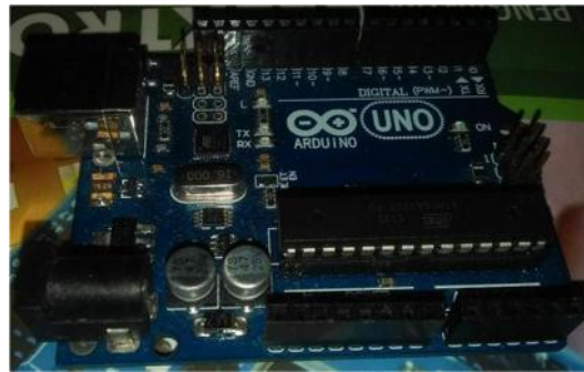
Gambar 3.5 Arduino Uno R3.
