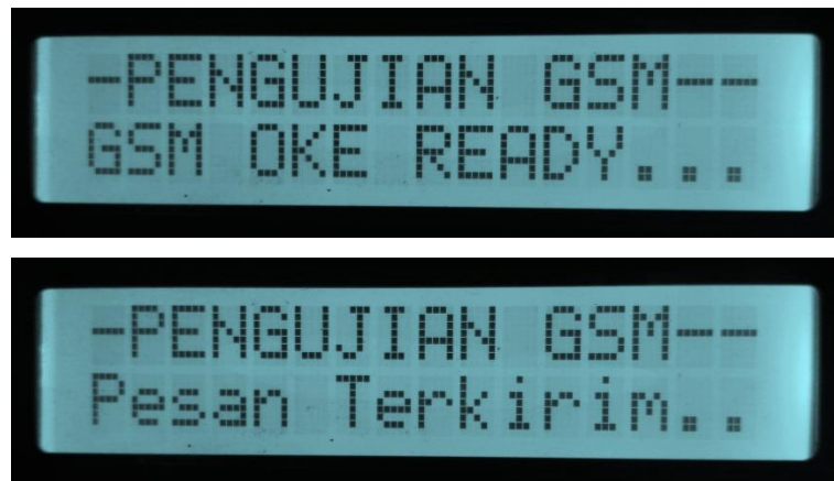
Gambar 4.10 Tampilan LCD Proses Inisialisasi GSM dan Pesan Terkirim
