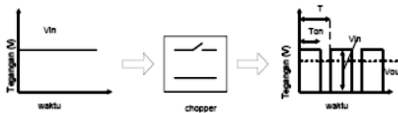
Gambar 2.5 proses perubahan tegangan arus searah ke arus searah dengan konverter DC ke DC (chopper)
