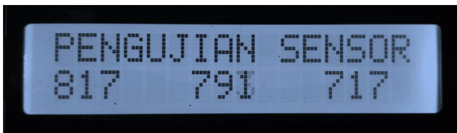
Gambar 4.8 Tampilan LCD Data Sensor Arus Dengan Beban
