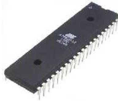
Gambar: 2.4 Bentuk fisik mikrokontroler ATmega32
