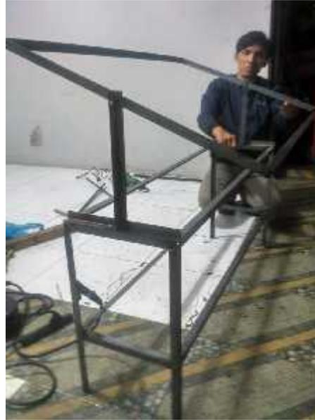
Gambar kerangka untuk penyangga panel surya
