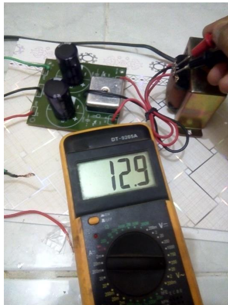
Gambar 4.8 Tegangan Input Rangkaian Tanpa Beban
