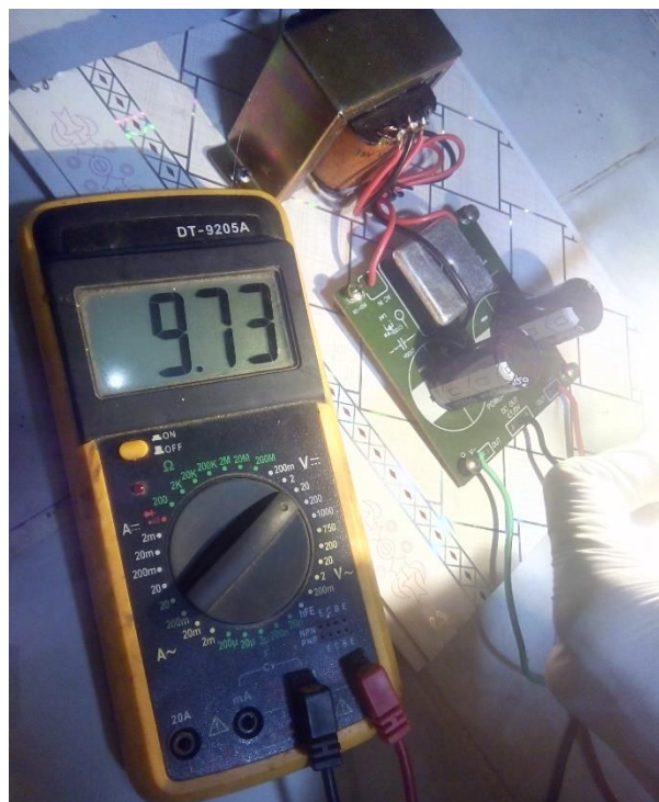
Gambar 4.13 Tegangan Output Rangkaian Dengan Beban
