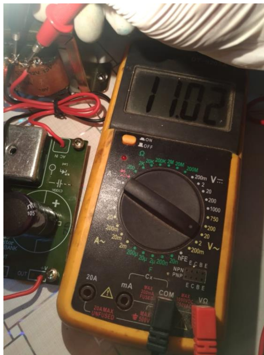
Gambar 4.11 Tegangan Input Rangkaian Dengan Beban
