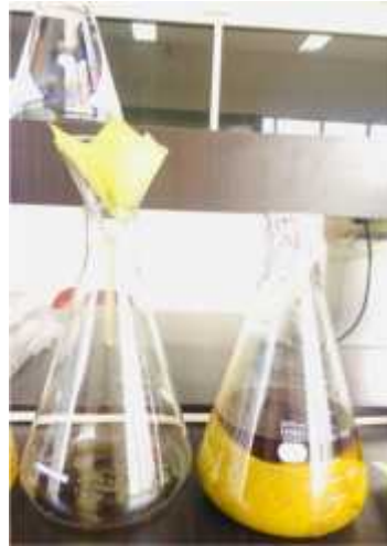
Penyaringan Ekstrak ethanol menggunakan kertas saring
