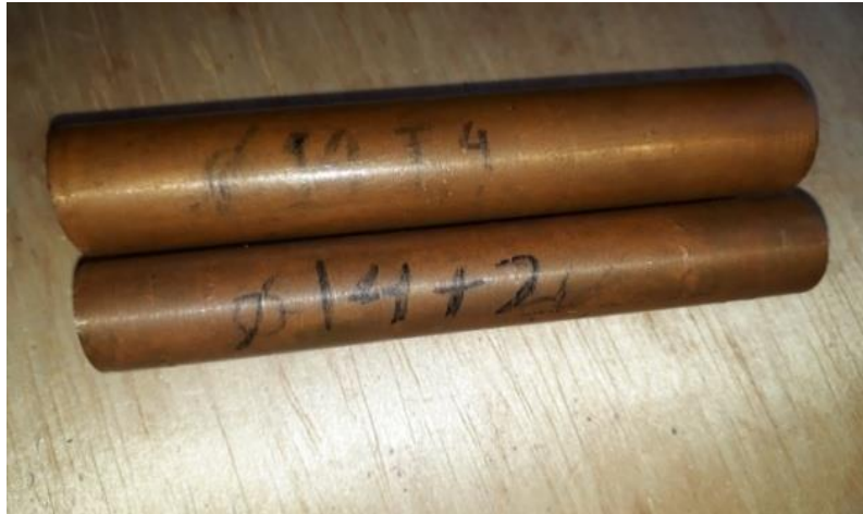
Gambar 3.10 Pipa tembaga diameter 13,84 mm.
