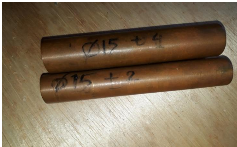
Gambar 3.11 Pipa tembaga diameter 15,76 mm
