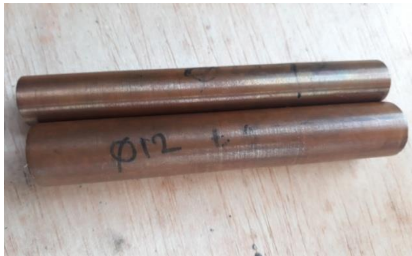
Gambar 3.9 Pipa tembaga diameter 11,74 mm.
