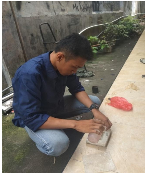
Gambar 3.17 Penuangan resin , lalu letakan serat kelapa sawit
