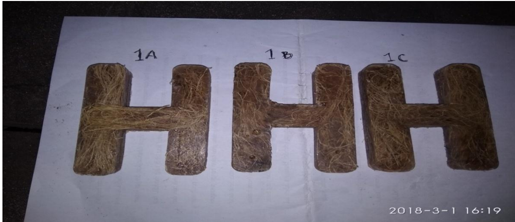
Gambar 4.1 Spesimen profi H dengan ketebalan 10 mm
