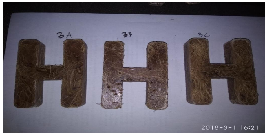
Gambar 4.3 Spesimen profil H dengan ketebalan 20 mm
