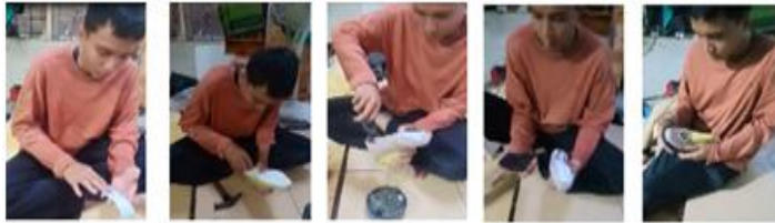
Gambar 6. Proses pemasangan tapak sepatu
