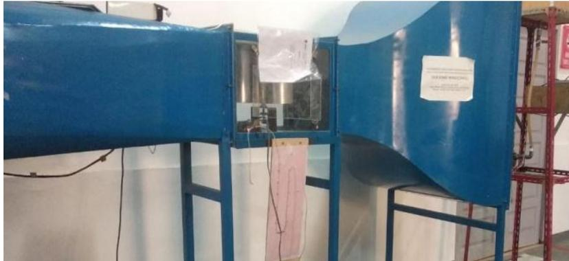
Gambar 3.1 Unit *wind tunnel* (Lab Proses Produksi UMSU)
