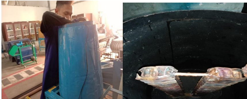
Gambar 4.11. Pemasangan Honeycomb ke tangki
