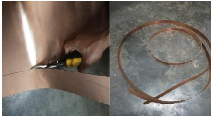
Gambar 4.4. Pemotongan Pelat Tembaga
