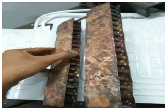
Gambar 4.10. Hasil Pengelasan Tutup
