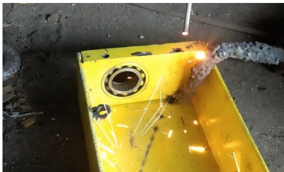
Gambar 4.24. Pengelasan Rumah Bearing ke Chasis
