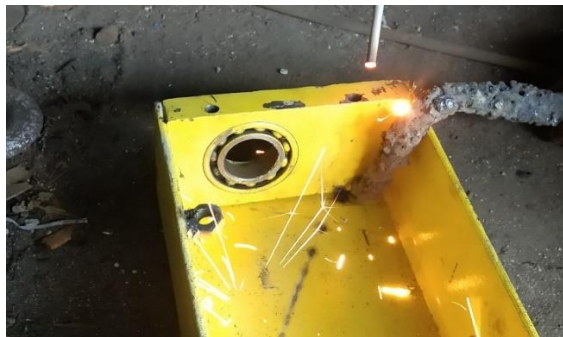
Gambar 4.6. Pengelasan Rumah Bearing Ke Chasis
