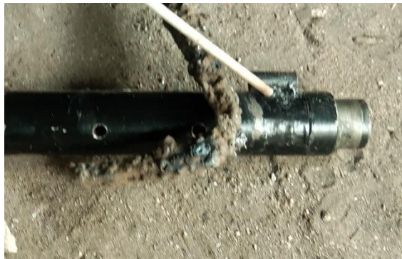
Gambar 4.14. Pengelasan Pegangan Pegas ke Poros
