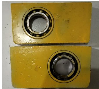
Gambar 4.27. Rumah Bearing yang Sudah Selesai
