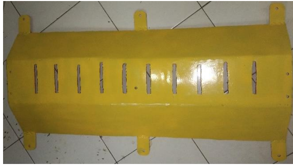
Gambar 4.44. Tutup Atas Yang Sudah Selesai
