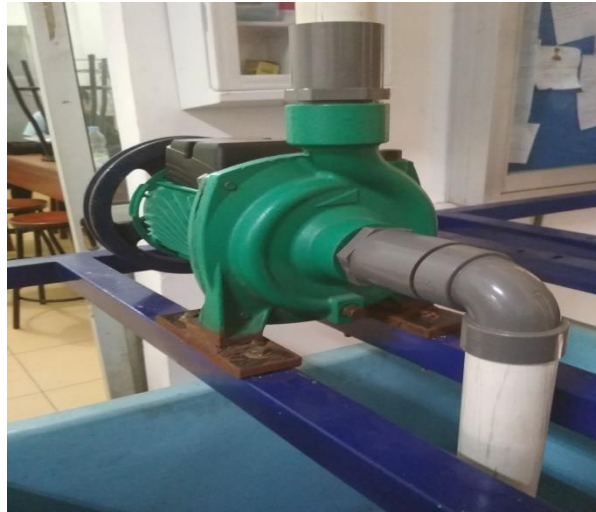
Gambar 3.17. Pompa 1,5 inchi sebagai turbin
