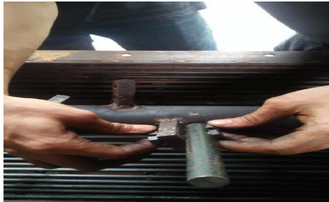
Gambar 4.2. Pemasangan Mata Pisau Pengurai silindris
