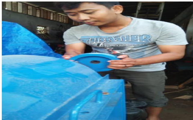
Gambar 4.4. Pemasangan Puli 6 inchi
