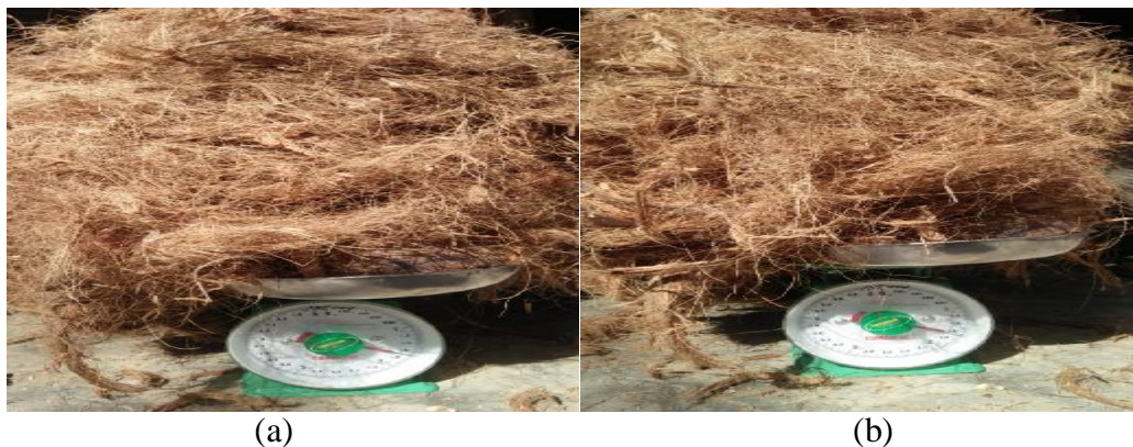
Gambar 4.14. (a) Hasil Penguraian Mata Pisau Persegi Panjang Dan (b) Silindris
