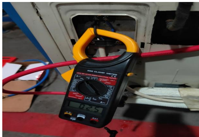
Gambar 3.40 Pengambilan Data Arus Listrik AC
