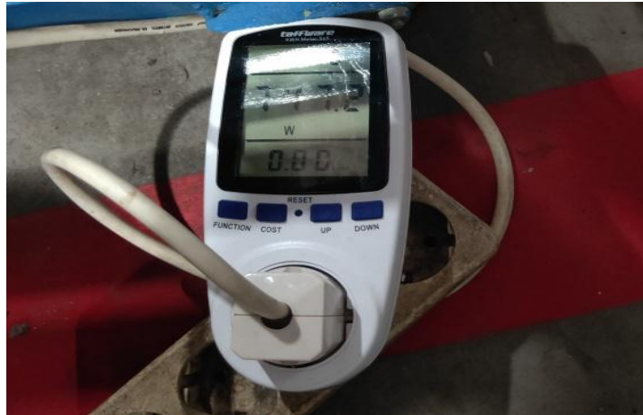
Gambar 3.39 Pengambilan Data Tegangan Listrik AC
