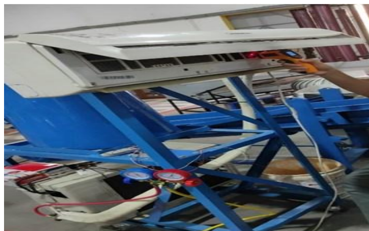
Gambar 3.38 Pengambilan Data Temperatur Evaporator
