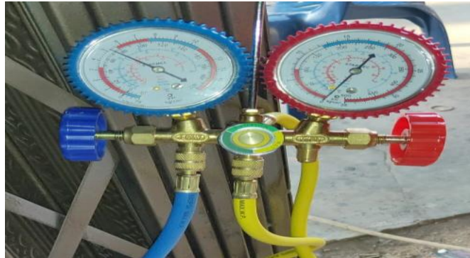
Gambar 3.36 Pengambilan Data Tekanan Refrigeran
