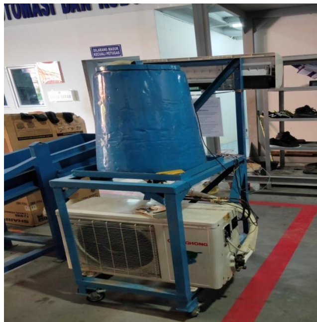
Gambar 3.30 Alat Pengujian AC Dengan Pemanas Air
