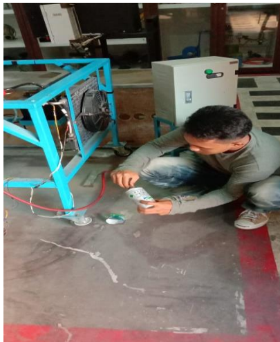
Gambar 4.7 Menghubungkan nippel pada tabung R-134a
