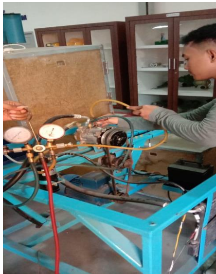
Gambar 4.3 Menyambung hose tengah
