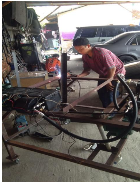
Gambar 4.1 Proses Pembuatan rangka dan perakitan komponen
