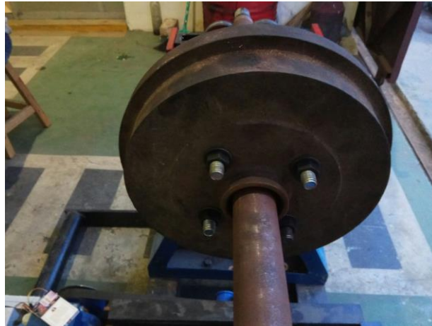
Gambar 3.22. pemasangan poros pada alat keseimbangan dinamik.
