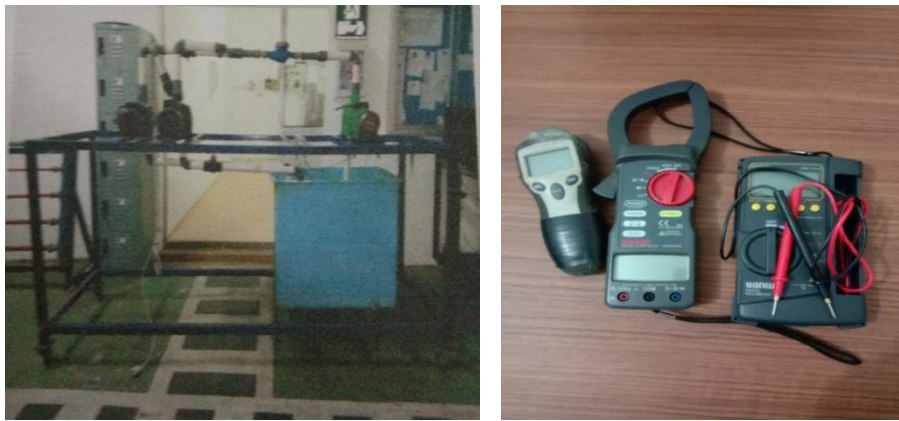
Gambar 4.1 Alat Uji Pompa Sebagai Turbin
