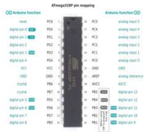
Gambar 2.6. Arduino Uno ATmega 328 Pin Mapping
