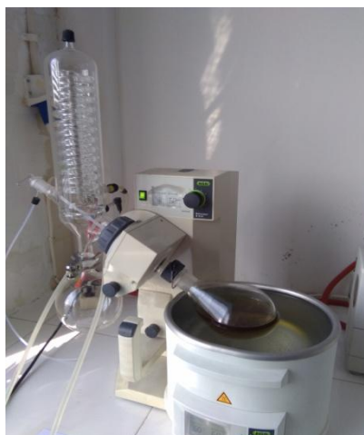
Gambar 9. Hasil saringan kulit kopi dipekatkan dengan alat vacum rotary evaporator selama 2 hari.
