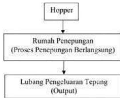
Gambar 2.19 Prinsip kerja mesin Disc Mill
