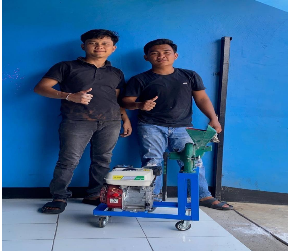
Gambar 4.15 Hasil Perancangan Mesin Penepung Cangkang Kerang Menjadi Tepung Berkapasitas 5Kg/Menit.
