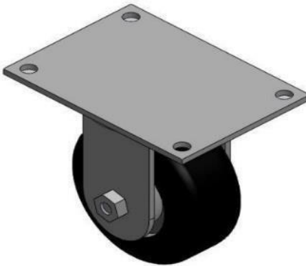
Gambar 4.28 Hasil Desain Roda.
