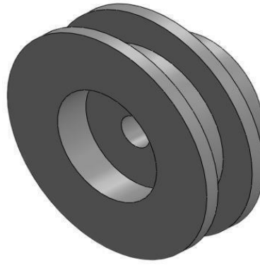
Gambar 4.4 Hasil Rancangan Pulley Pada Motor
