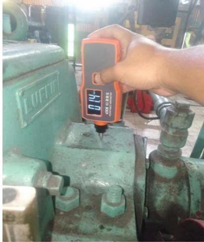
Gambar 4.4 Hasil Pengukuran Vibrasi *bearing bull gear 1* pada shaft depan 0,20mm/s dan 0,14mm/s
