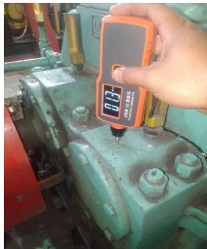
Gambar 4.5 Hasil Pengukuran Vibrasi *bearing bull gear 2* pada shaft belakang 0,27mm/s dan 0,13mm/s
