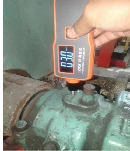
Gambar 4.2 Hasil Pengukuran Vibrasi *bearing* pinion 1 pada shaft depan 0,26mm/s dan 0,30mm/s
