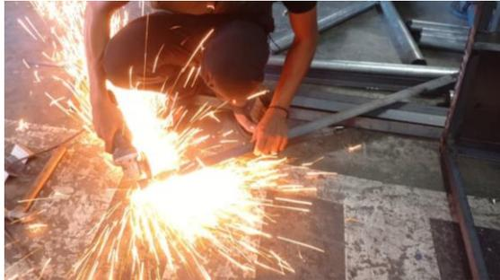
Gambar 4. 13 Pemotongan Material
