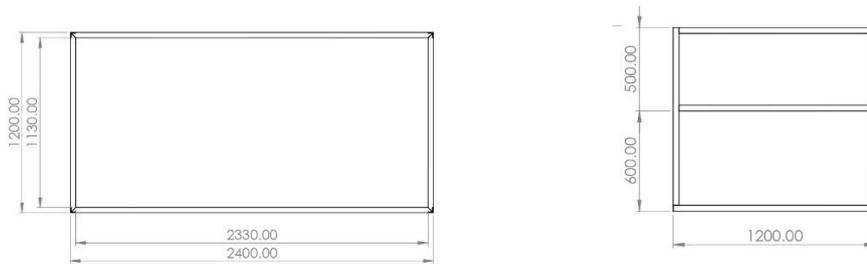
Gambar 4. 2 Spesifikasi bak penampung gabah
