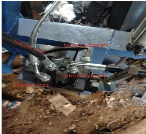
Gambar 4. 29 Rangkaian pemasangan selang hidrolik ke valve
