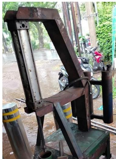
Gambar 4. 28 Hasil pemasangan hidrolik
