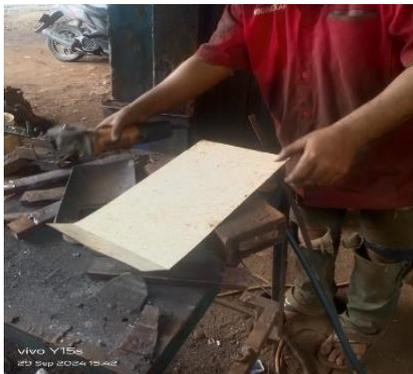
Gambar 4. 25 Pemotongan plat lajur pembuangan
