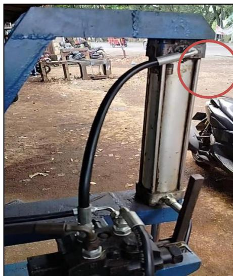
Gambar 4. 30 Pemasangan selang dari valve ke hidrolik
