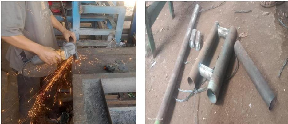
Gambar 4. 12 Proses pengukuran dan pemotongan pipa
