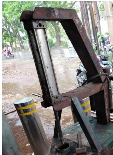
Gambar 4. 8 Hasil penyambungan rangka hidrolik
