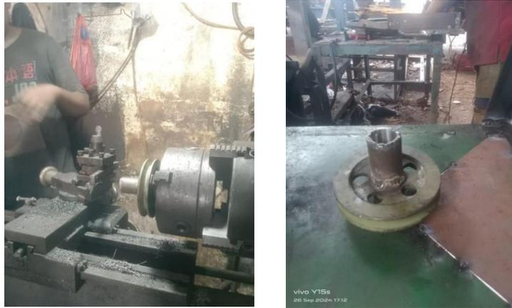
Gambar 4. 21 Pembubutan pulley dinamo ke pompa
