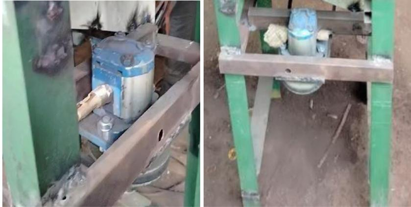
Gambar 4. 5 hasil pembuatan dudukan pompa hidrolisk
