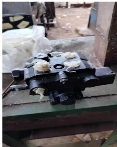
Gambar 3. 11 valve hidrolik
