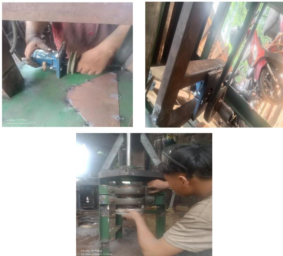
Gambar 4. 22 Pemasangan pulley pompa motor dan pulley poros
