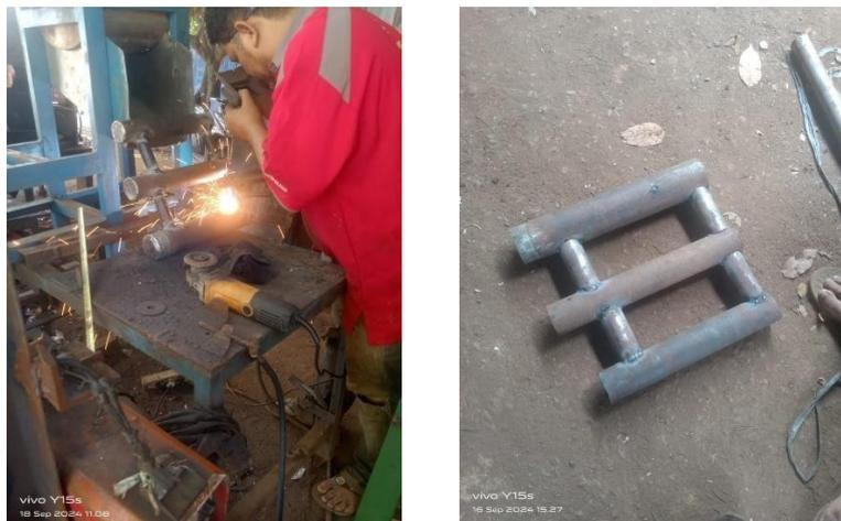
Gambar 4. 13 Proses penyambungan pipa
