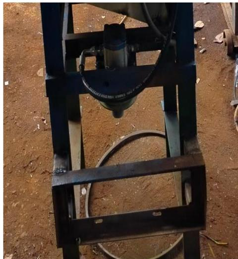
Gambar 4. 6 hasil pembuatan rangka dudukan dinamo
