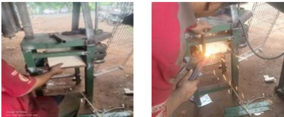
Gambar 4. 26 Proses penyambungan lajur pembuangan
