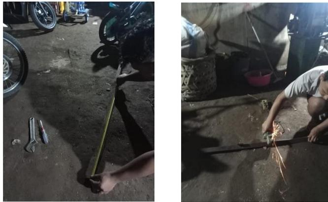
Gambar 4. 3 proses pengukuran dan pemotongan
