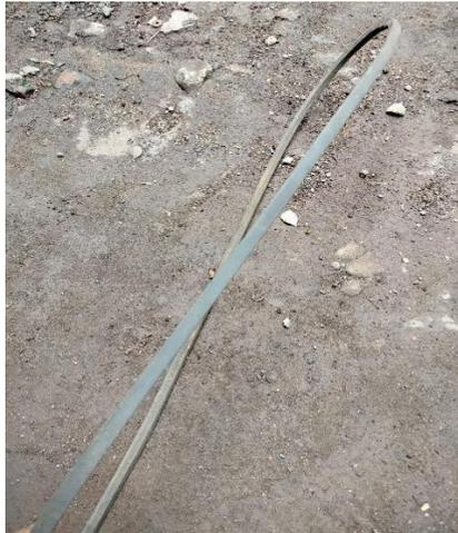
Gambar 3. 10 belt (sabuk mesin)
