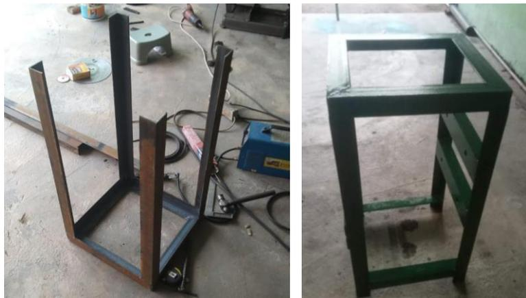
Gambar 4. 4 hasil penyambungan rangka bawah dan atas
