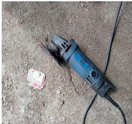
Gambar 3. 18 Mesin grinda
