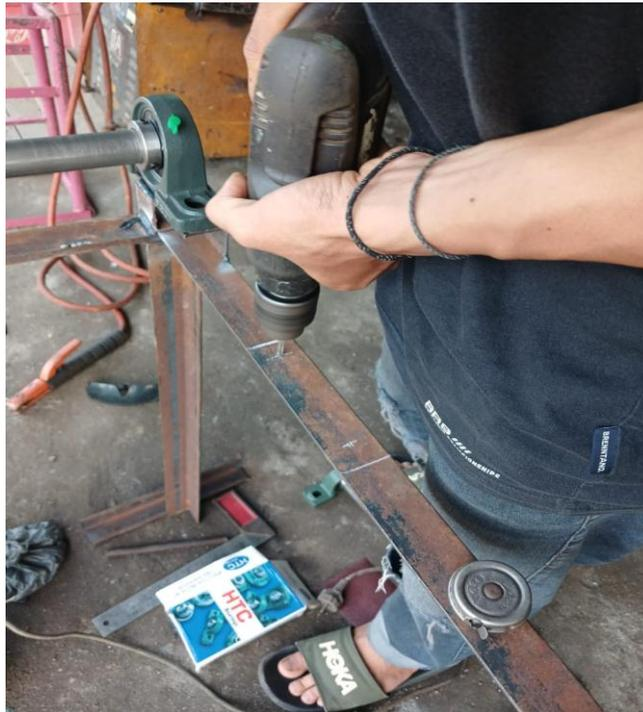
Gambar 4. 22 Proses Penyambungan baut
