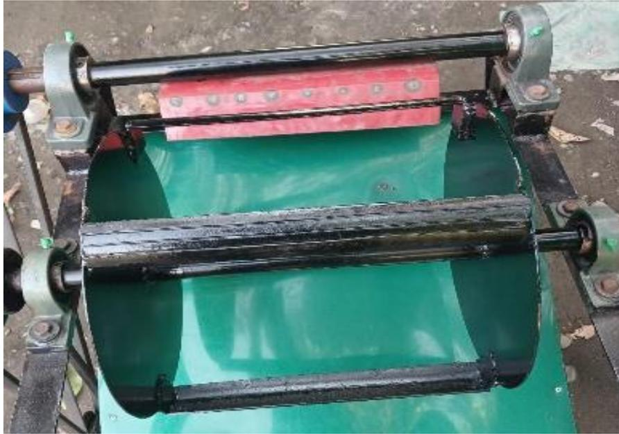
Gambar 4. 24 Hasil Pembuatan *Roller*
