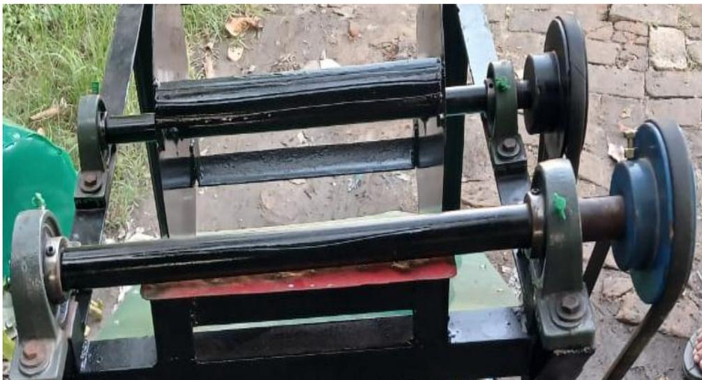
Gambar 4. 25 Pemasangan Poros Dan *Pulley*
