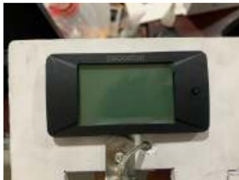
Gambar 3. 10 Sensor Arus Pzem 025
