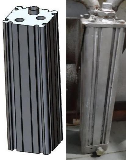
Gambar 4.7 Hasil Pembuatan Tabung Anti *Fire Back*
