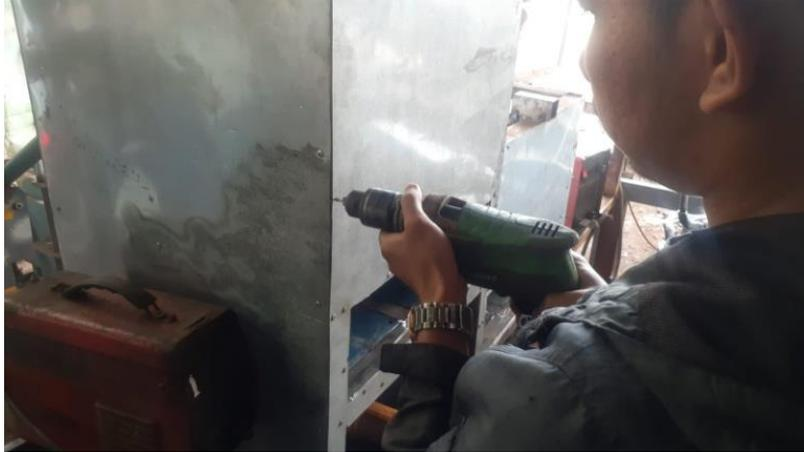
Gambar 4.15 Proses Perakitan *Cover* Rangka
