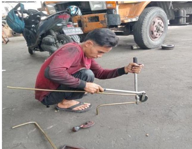
Gambar 4.10 Proses Pembengkokan Selang Penghubung
