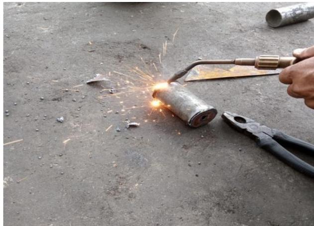
Gambar 4.14 Proses Pengelasan Tabung Kondensor
