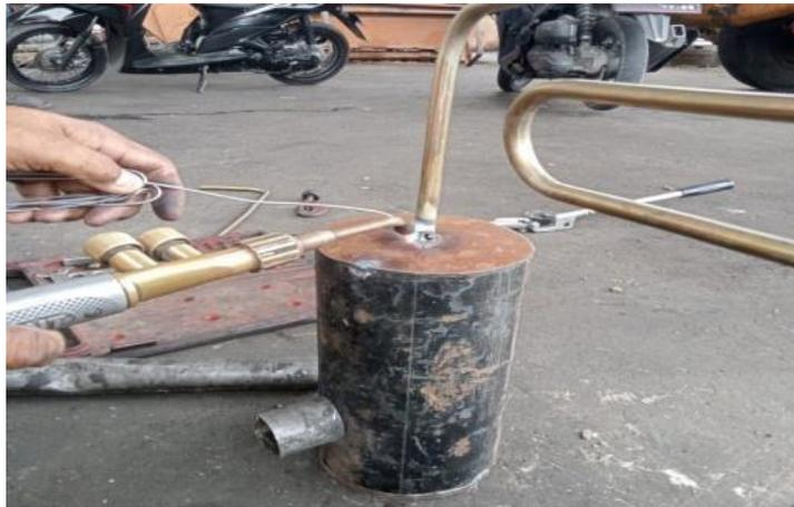
Gambar 4.13 Proses pembengkokan selang penghubung
