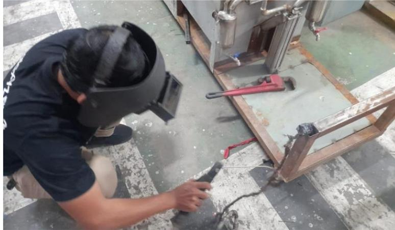
Gambar 4.9 Proses Pengelasan Rangka
