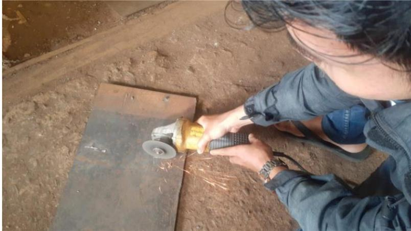
Gambar 4.11 Pemotongan Plat Untuk Tabung Reaktor
