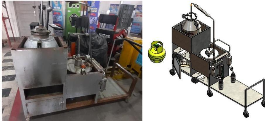
Gambar 4.1 Hasil Pembuatan Alat Pirolisis Sampah Plastik
