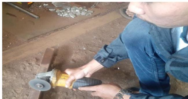
Gambar 4.8 Proses Pemotongan Besi *Hollow*
