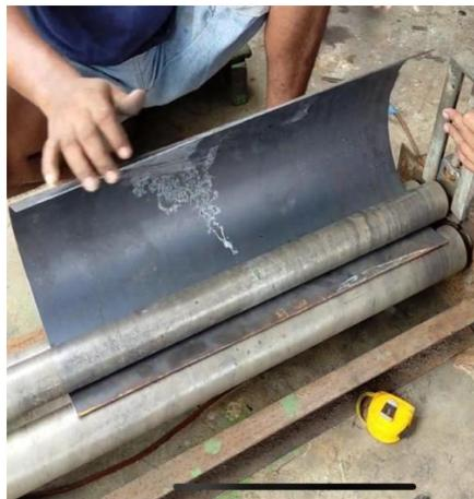
Gambar 4.12 Membentuk Plat Besi Menggunakan Mesin *Roll*
