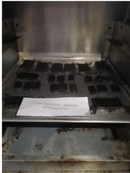
Gambar 4.28 Proses sintering atau pemanasan
