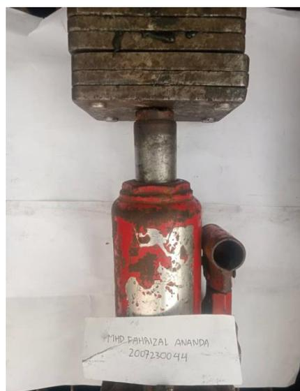
Gambar 4.26 Proses kompaksi atau penekanan
