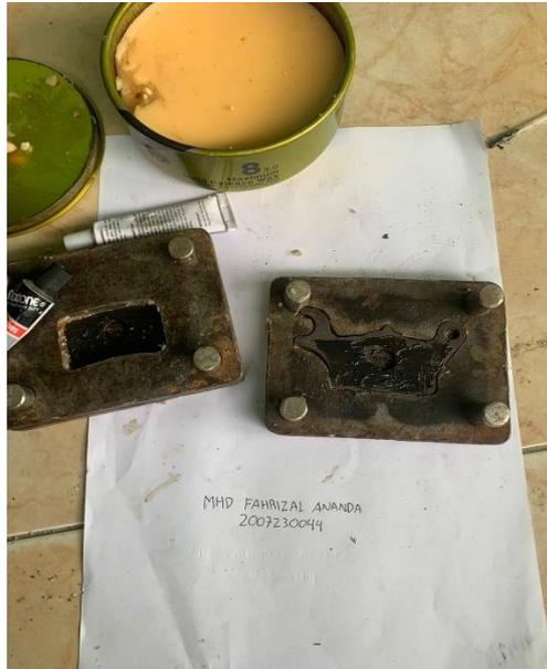
Gambar 4.23 Memasukan plat kedalam cetakan
