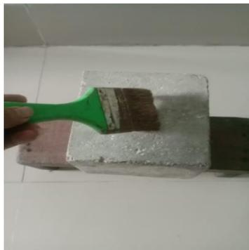
Gambar 4.26 pembersihan spesimen
