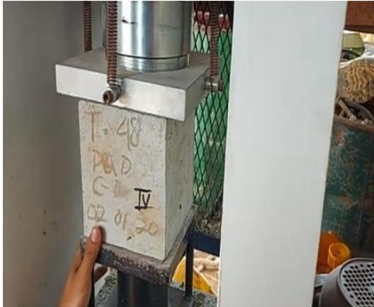
Gambar 4.27 memasang spesimen pada mesin uji tekan
