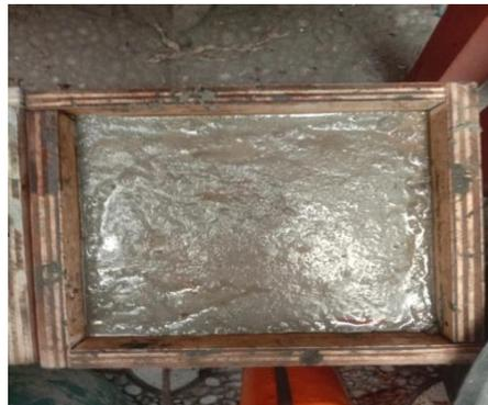
Gambar 4.22 Cetakan spesimen yang mengeras
