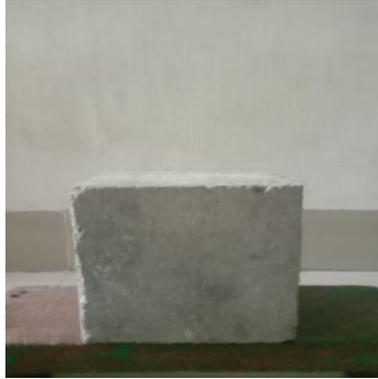
Gambar 4.24 penyiapan spesimen uji tekan
