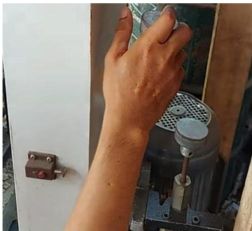
Gambar 4.28 pengaturan tuas mesin uji tekan
