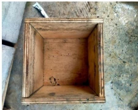
Gambar 4.17 cetakan spesimen uji tekan
