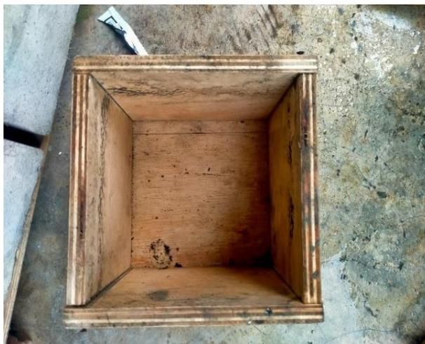
Gambar 3.9 Cetakan Sepesimen Uji Tekan
