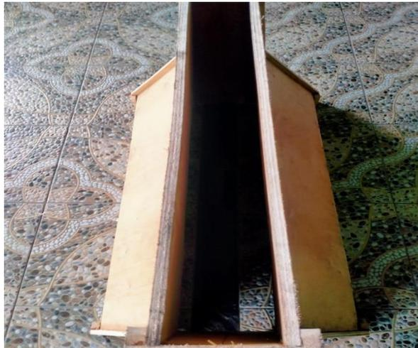
Gambar 4.1 Cetakan *Road barrier*
