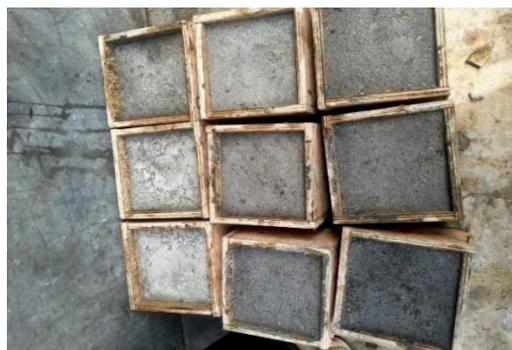
Gambar 4. 9 Hasil Cetakan Spesimen Yang Mengeras
