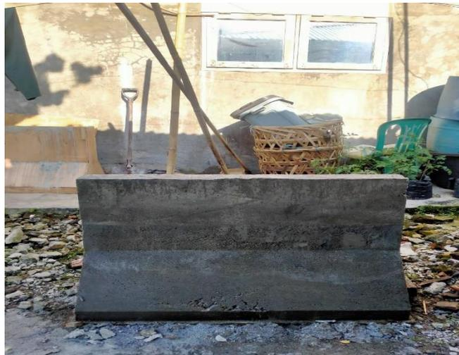
Gambar 4.6 Hasil Cetakan *Road Barrier*
