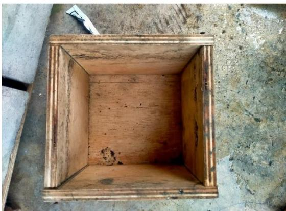
Gambar 3.8 Cetakan Sepesimen Uji Tekan
