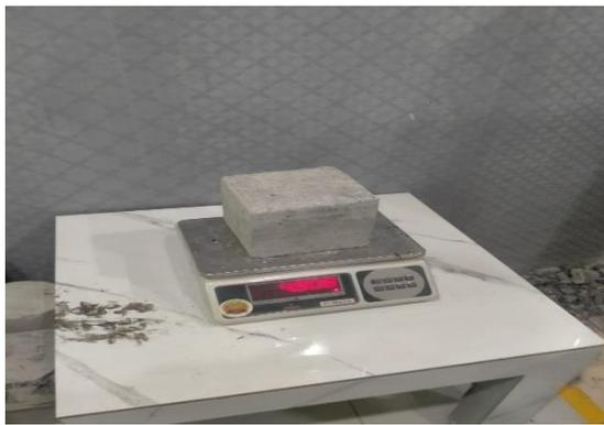
Gambar 4.13 Menimbang spesimen
