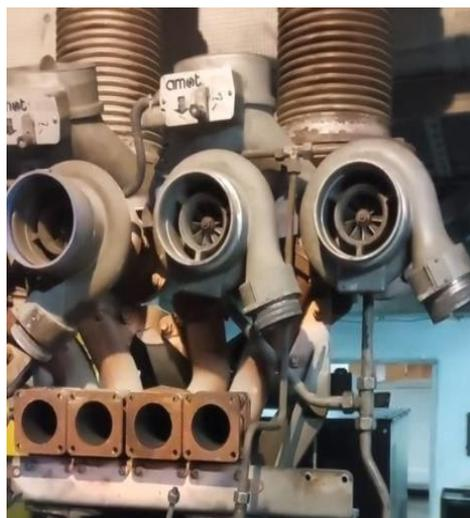
Gambar 2.10 *Turbocharger* (Hyundai, Mengenal Turbocharger dan Fungsinya)
