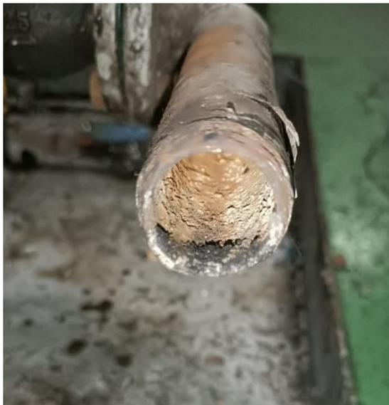
Gambar 4.4 Bagian Dalam Pipa Yang Terkena Korosi Air Laut
