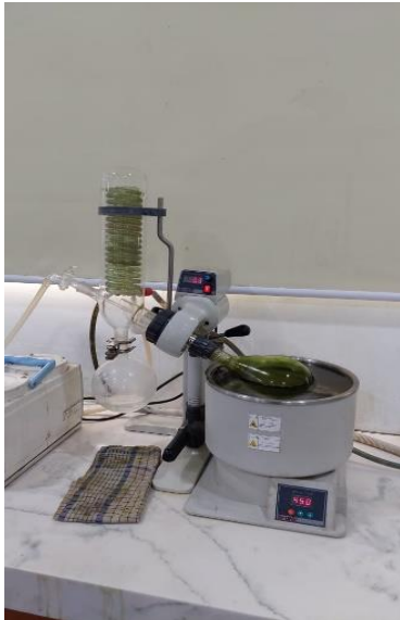
Pengentalan ekstrak dengan rotary Evaporator.
