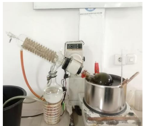
Pengentalan ekstrak biji cokelat menggunakan rotary evaporator
