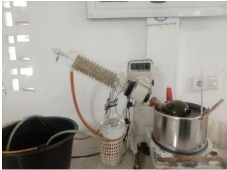
Pengentalan ekstrak biji kakao menggunakan rotary evaporator
