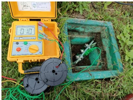
Tahanan pentanahan blok kontrol No. 3
