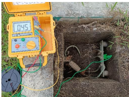
Tahanan pentanahan blok kontrol No. 4
