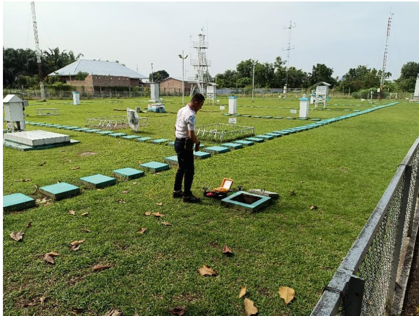
Gambar 4.24. Pelaksanaan pengukuran tahanan pada blok kontrol 1
