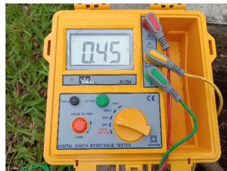
Tahanan pentanahan blok kontrol No. 4
