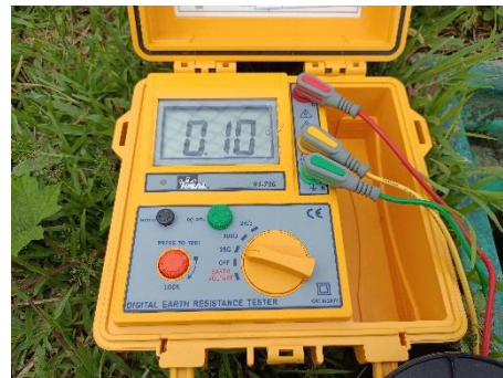
Tahanan pentanahan blok kontrol No. 3
