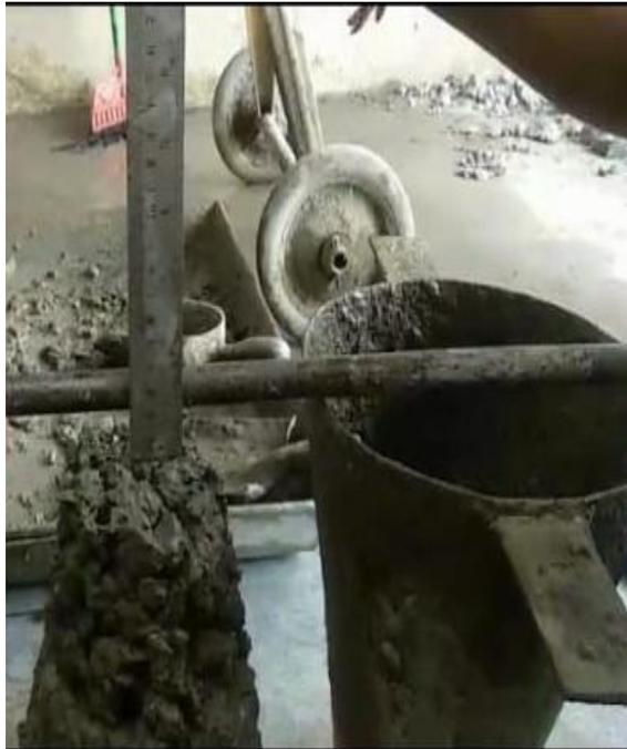
Lampiran 26 : Pengujian Slump Test.
