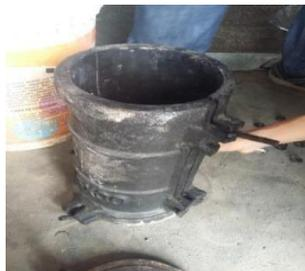
Gambar 3.1 : Cetakan beton silinder 15x30cm
