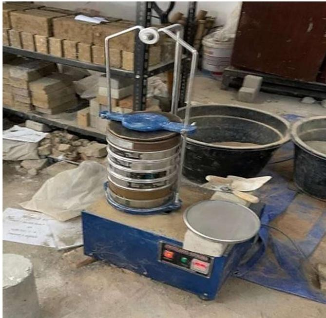
Gambar L 2 : Pengujian Analisa Saringan
