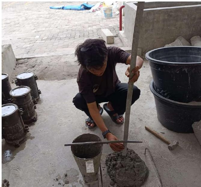
Gambar L 6 : Slump Test
