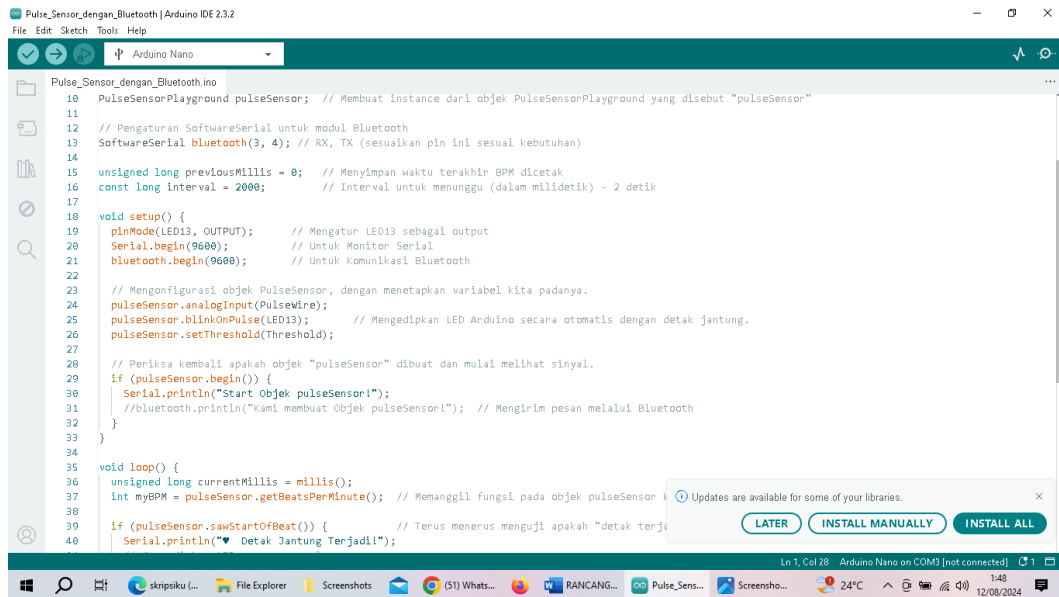
Gambar 4.5. Kode Yang Menghubungkan Pulse Sensor dan Bluetooth HC 05
